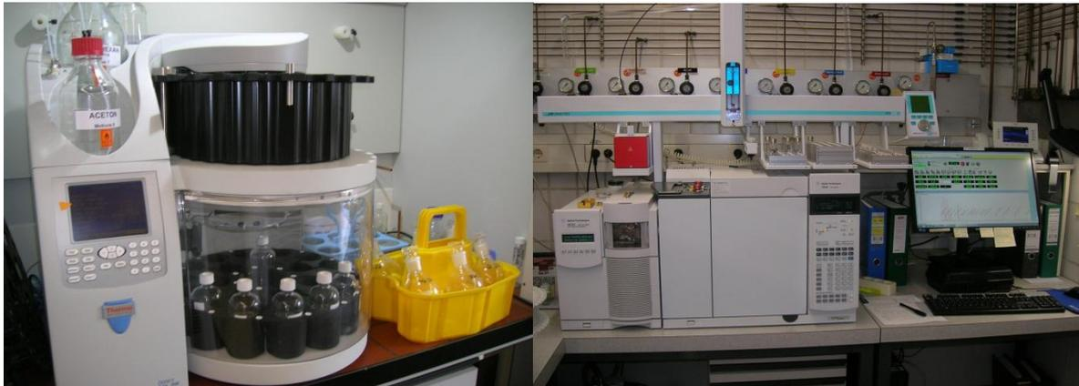
Fotos: ASE-Extraktor sowie Gaschromatographie / Massenspektrometrie System
