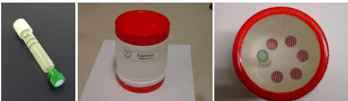
Abbildung 23: NO 2 -Passivsammler mit Membran (grüner Teil), Wettergeschutzhaube und Wettergeschutzhaube mit Insektenschutz
